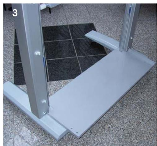
3. Den auf das Geha Board voreingestellten Rahmen mit den Sechskantmuttern M8 inklusiv Unterlegscheiben rückseitig an die Führungswagen der Pylonen schrauben, siehe Foto 4. Dazu vorher die vier Muttern lösen! Darauf achten, dass die U-förmigen Schellen an die Unterseite des Rahmens kommen.
