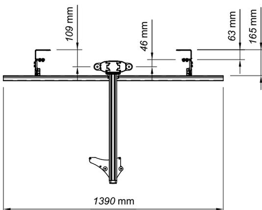
Höhenverstellung für interaktive Boards mit Kurzdistanzbeamer - elektrisch, wandmontiert
